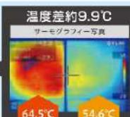
塗料を塗布したサイディングに約1時間ランプ照射し、塗膜の表面温度を測定。一般的な塗料と比較して、約9.9°Cの温度差があり、優れた遮熱性を発揮することが確認された。
